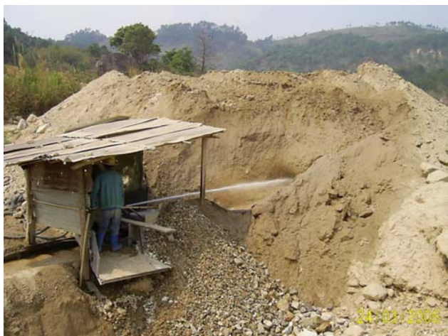
รูปที่ 2 การฉีดหินผุ-ดินทรายที่มีแร่ปะปนอยู่ให้แยกตัวอิสระจากกันและไหลเข้าสู่รางกู๋แร่
