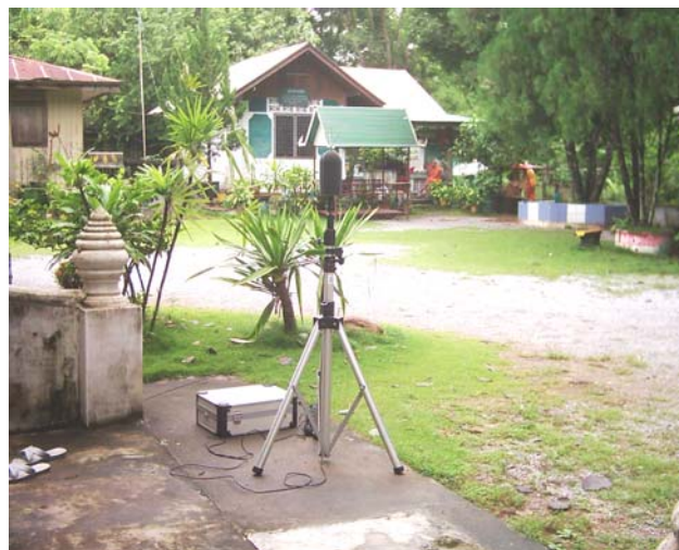
รูปที่ 8 การตรวจวัดระดับเสียง บริเวณหน้าอุโบสถวัดวังโป่ง
