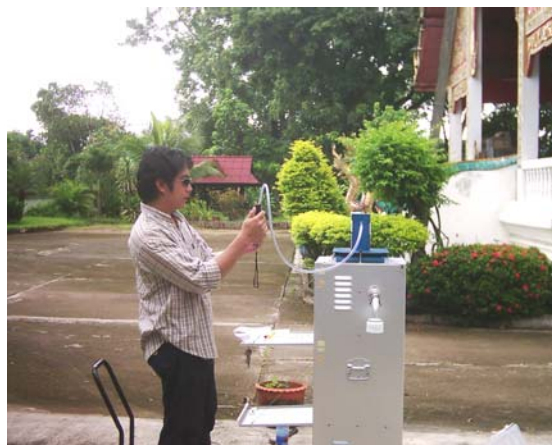
รูปที่ 4 การเก็บตัวอย่างปริมาณฝุ่นละอองรวม (TSP) บริเวณวัดวังหม้อ
