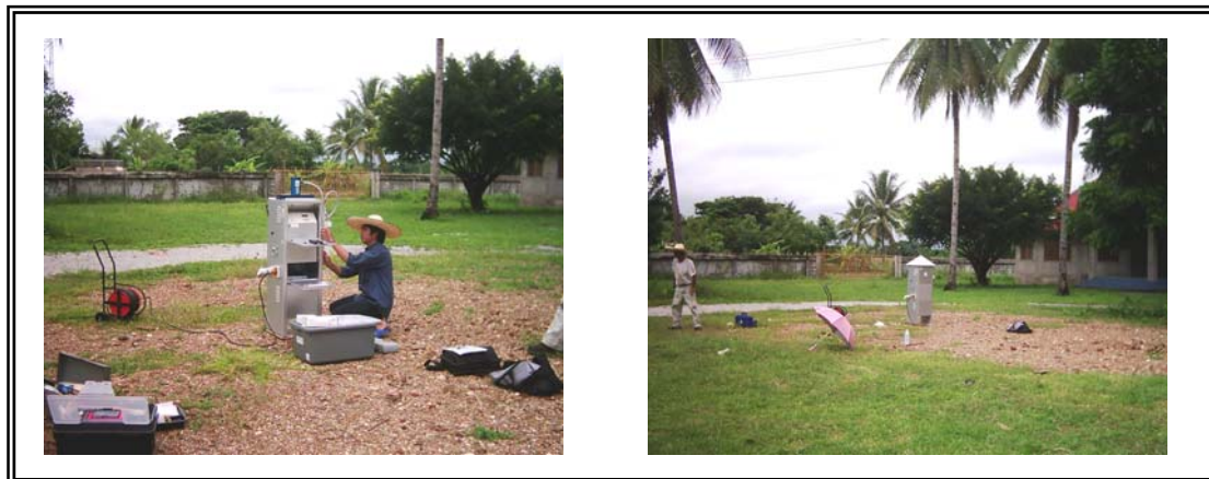
รูปที่ 3 การเก็บตัวอย่างปริมาณฝุ่นละอองรวม (TSP) บริเวณวัดวังโป่ง
