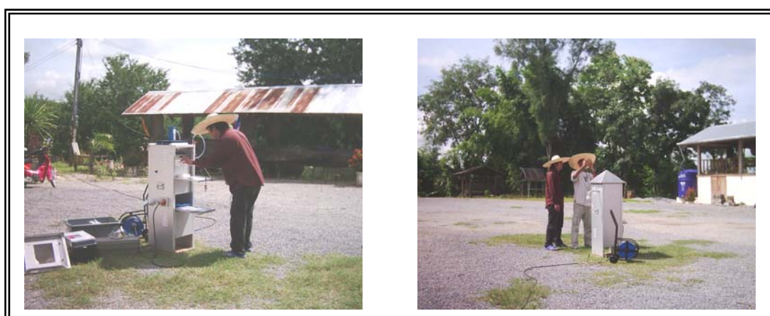
รูปที่ 2 การเก็บตัวอย่างปริมาณฝุ่นละอองรวม (TSP) บริเวณวัดกาศผาแพร่
