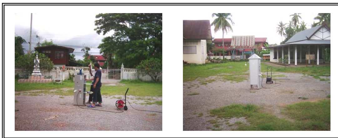
รูปที่ 6 การเก็บตัวอย่างปริมาณฝุ่นละอองรวม (TSP) บริเวณวัดร่องกวาง
