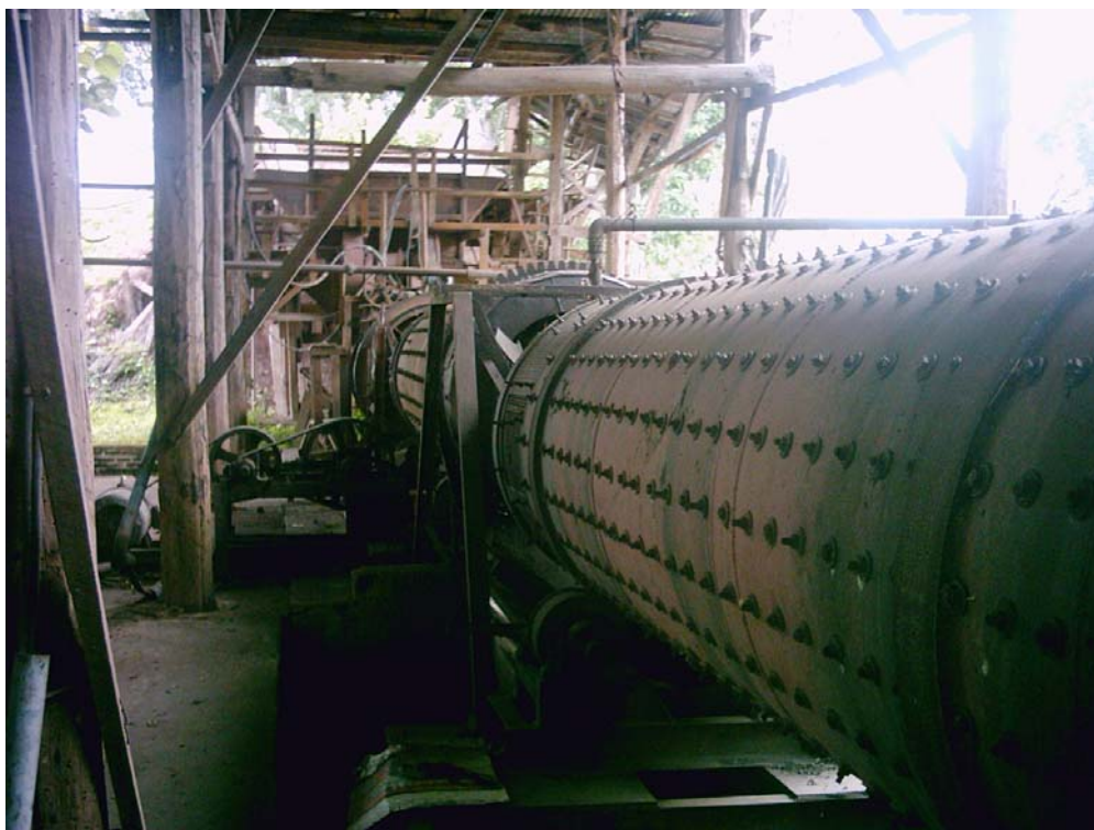
รูปที่ 9 เครื่องล้าง-คัดขนาด ชุดเดิมที่อยู่ในสภาพใช้งานได้ (แต่เกิดเสียงดังมาก)
