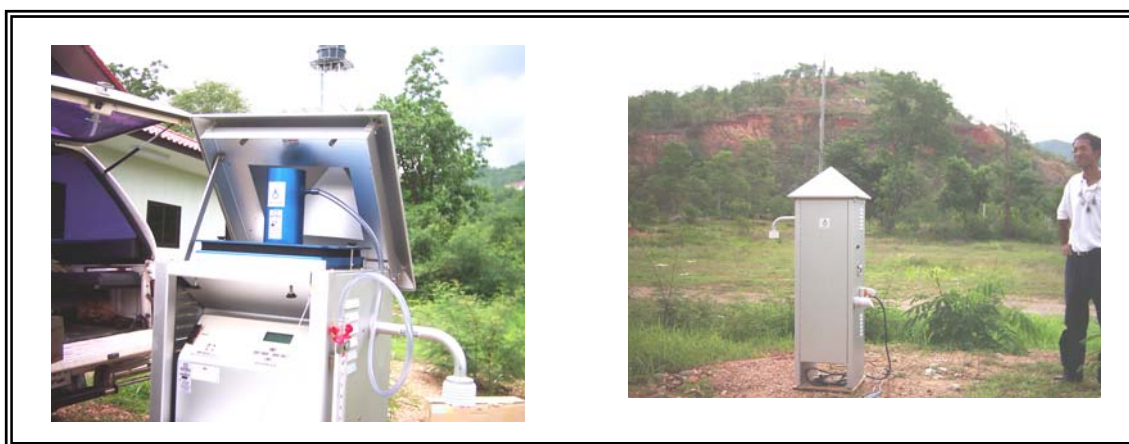
รูปที่ 3 การตรวจวัดปริมาณฝุ่นละอองรวมในบรรยากาศ บริเวณสถานที่ก่อสร้างสำนักงาน อบต.ป่าพลู (ใหม่) (2)
