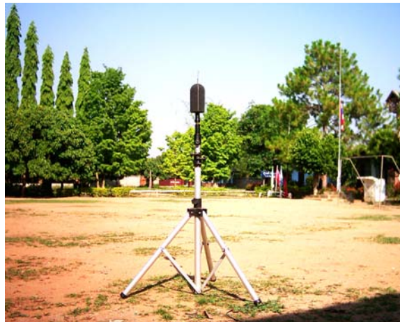
รูปที่ 6 แสดงการดำเนินการตรวจวัดระดับเสียงบริเวณสนามหญ้าโรงเรียนบ้านแม่แนต
