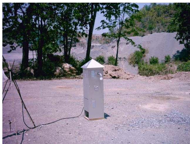
รูปที่ 3 การวัดปริมาณฝุ่น บริเวณทางเข้าโรงไม้หิน
