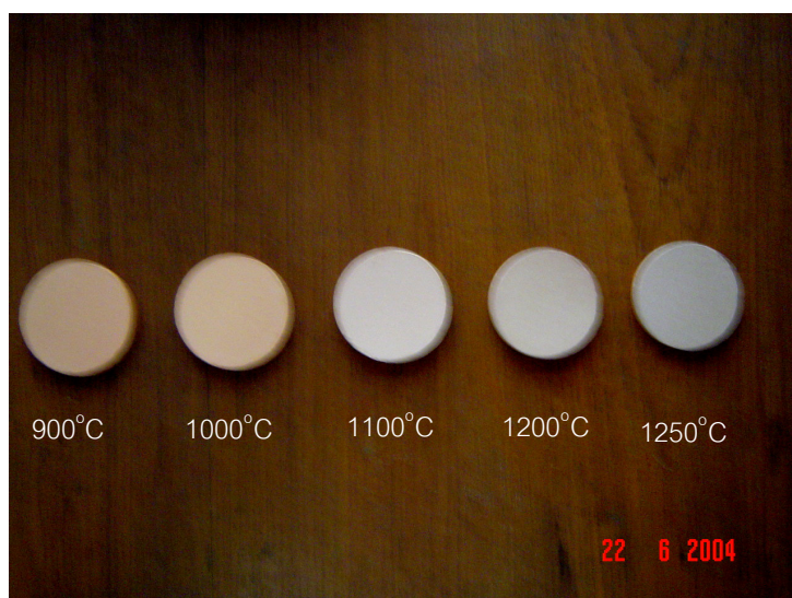
รูปที่ 2.4 แสดงสีของตัวอย่าง PJ-1 เเผาที่อุณหภูมิต่างกัน
