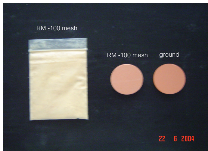
รูปที่ 3.10 แสดงสีของดิน PJ-7 ก่อนเผาและหลังเผาที่ 1200°C
