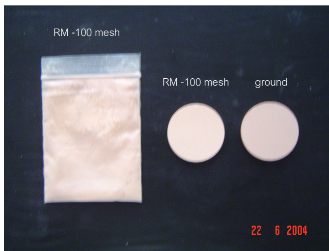
รูปที่ 3.11 แสดงสีของดิน PJ-8 ก่อนเผาและหลังเผาที่ 1200°C
