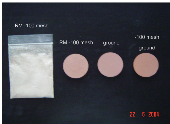
รูปที่ 3.9 แสดงสีของดิน PJ-6 ก่อนเผาและหลังเผาที่ 1200°C
