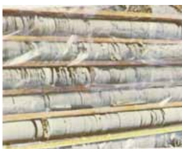
ภาพแท่งตัวอย่าง ที่ได้จากการเจาะ สำรวจ และจัดเก็บ อย่างเป็นระบบ
