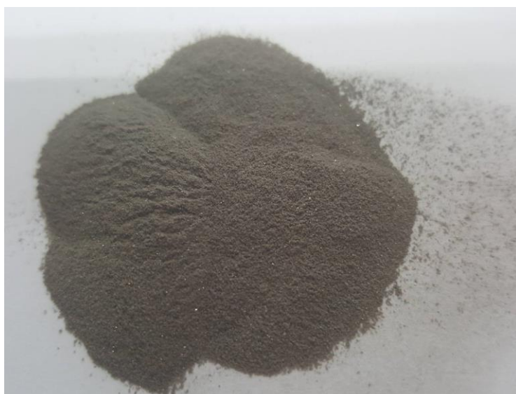
รูปที่ 4.6 แสดงลักษณะของหัวแร่ที่ผ่านการแต่งแร่ด้วยโต๊ะแยกแร่
