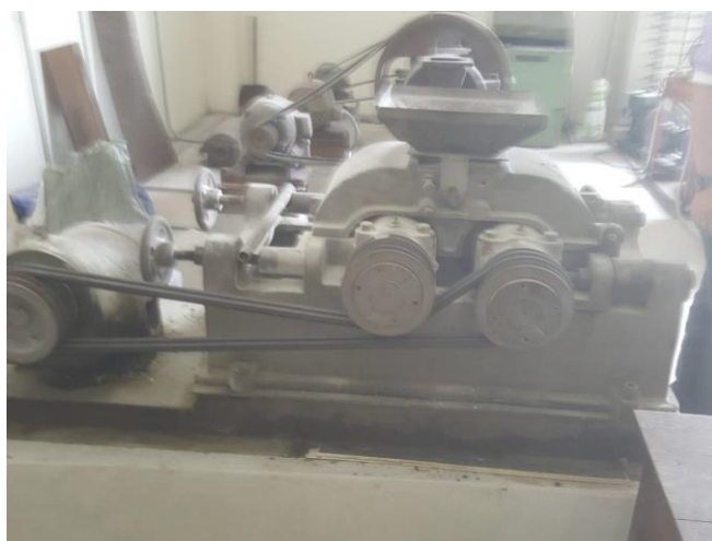
รูปที่ 3.4 เครื่องย่อยแร่แบบลูกกลิ้ง (Roll Crusher) ที่ใช้ในการทดลอง
