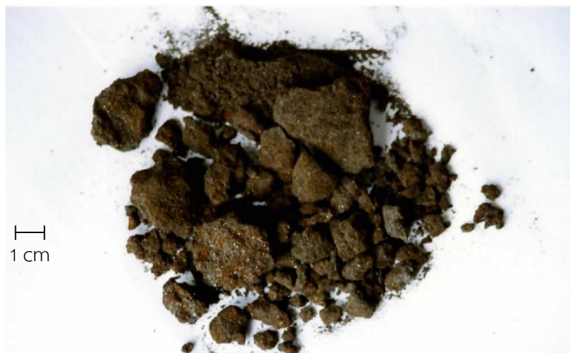
รูปที่ 4.9 หัวแร่ที่ผ่านการแต่งแร่ด้วยโตะแยกแร่หลังผ่านการบดด้วยเครื่องบดแร่แบบบดด้วยท่อนเหล็ก (Rod Mill)
