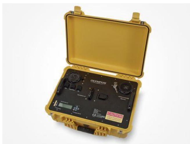
รูปที่ 3.32 เครื่องวิเคราะห์ชนิดแร่ด้วยรังสีเอกซ์เลี้ยวเบน (X-Ray Diffractometer) แบบพกพาของ OLYMPUS
