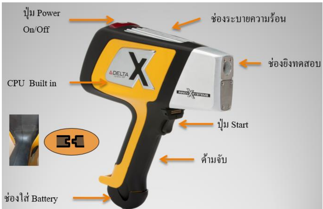
รูปที่ 3.28 ส่วนประกอบตัวเครื่อง XRF แบบพกพาของ OLYMPUS
