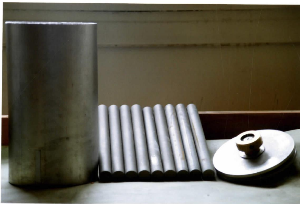
รูปที่ 3.17 แสดงเครื่องบดแร่แบบบดด้วยท่อนเหล็ก (Rod Mill) ที่ใช้ในการทดลอง
