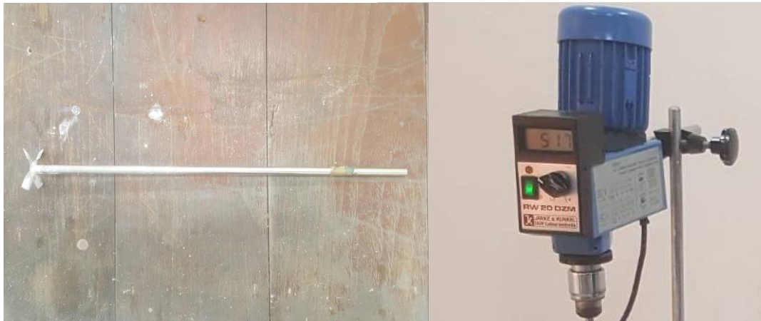
รูปที่ 3.27 ก) ใบกวนแร่ (Two-Bladed Stirrer) ข) มอเตอร์
