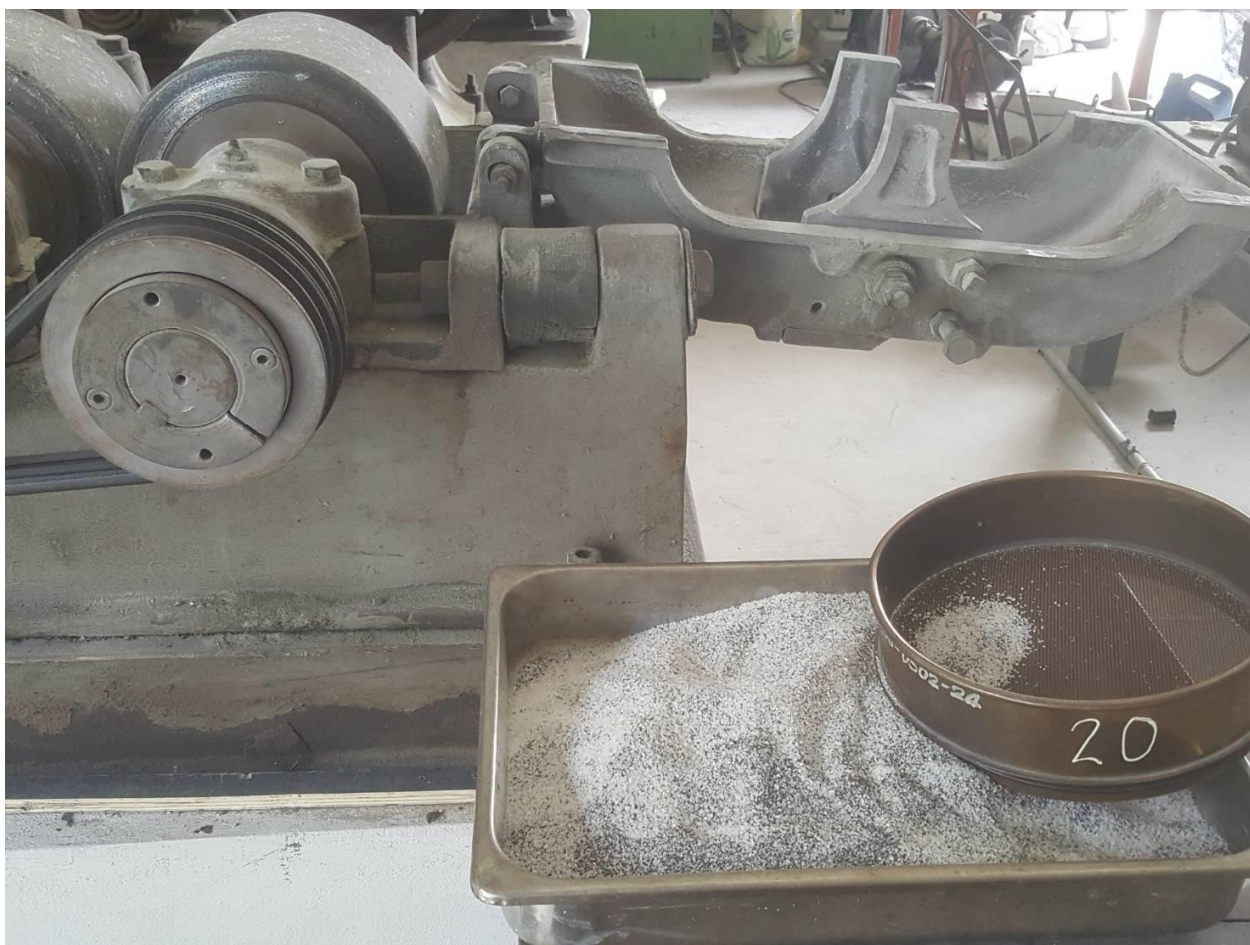
รูปที่ 4.4 ลักษณะแร่ภายหลังการผ่านการย่อยแร่ด้วยเครื่องย่อยแร่แบบลูกกลิ้ง (Roll Crusher)
