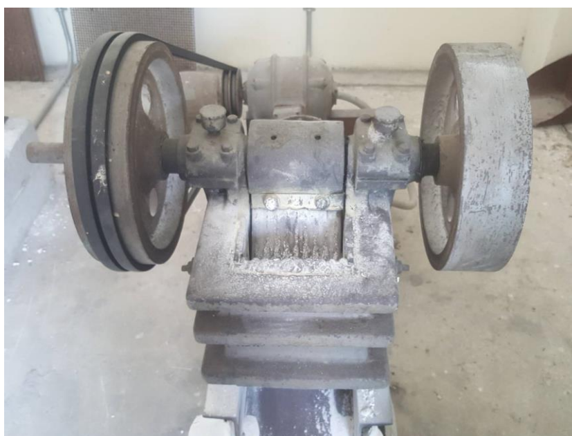
รูปที่ 3.2 เครื่องย่อยแร่แบบปากขบ (Jaw Crusher) ที่ใช้ในการทดลอง
