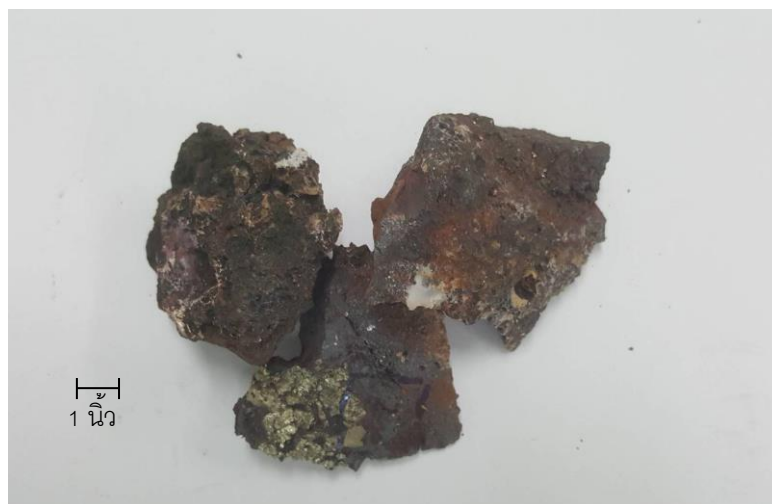
รูปที่ 4.3 ลักษณะของแร่ก่อนเข้าสู่กระบวนการบดหยาบ
