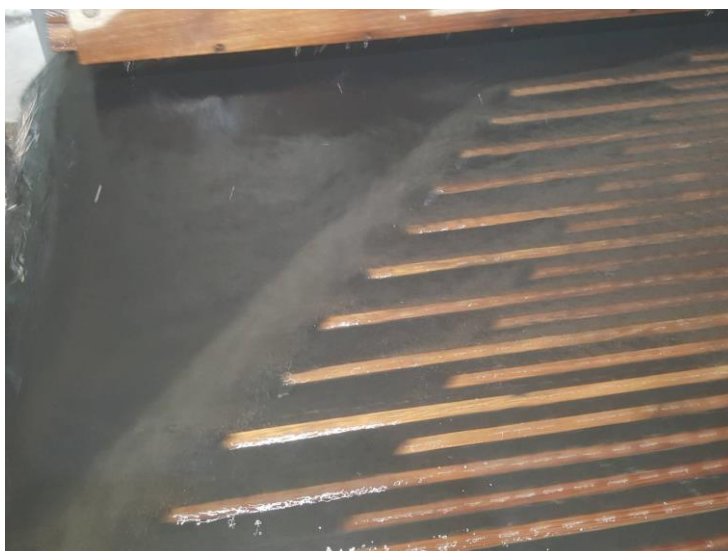
รูปที่ 4.5 แสดงลักษณะหัวแร่บนโต๊ะแยกแร่
