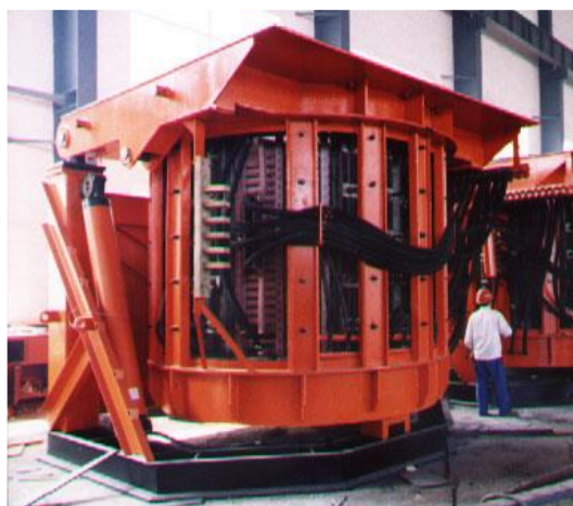
รูปที่ 3.9 เตาหลอมโลหะโดยการเหวียน้ำ (กรมพัฒนาพลังงานทดแทนและอนุรักษ์พลังงาน, 2552)
