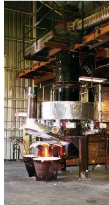
รูปที่ 3.2 เตาคิวโปลา (Cupola Furnace) (กรมพัฒนาพลังงานทดแทนและอนุรักษ์พลังงาน, 2553)
