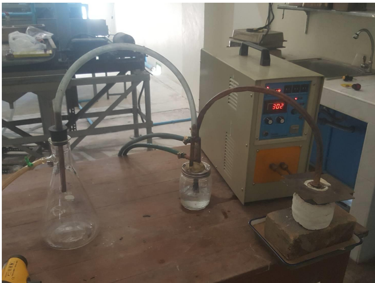
รูปที่ 4.10 แสดงเตาเหนียวน้ำและอุปกรณ์ต่อพ่วงสำหรับจับเก็บไอระเหยตัวด้วยน้ำ
