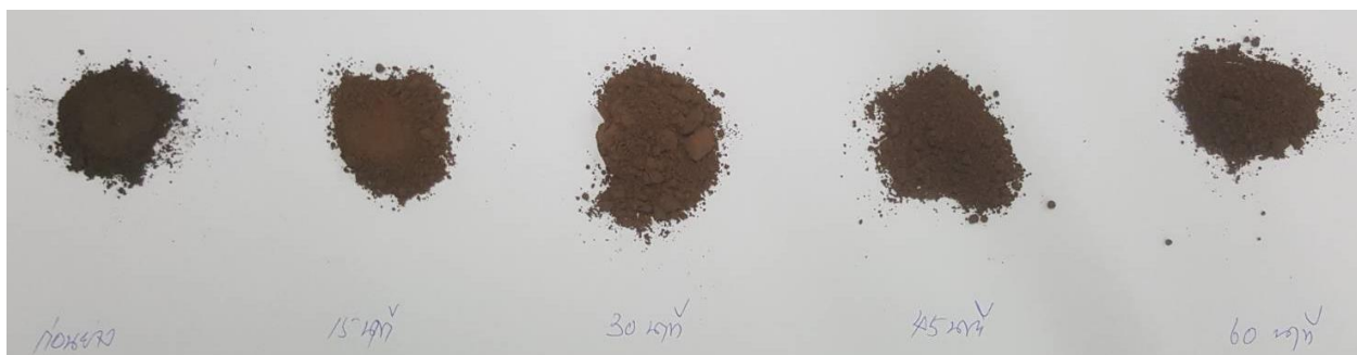
รูปที่ 4.1 แสดงลักษณะของฝุ่นเหล็กก่อนย่าง และหลังย่างที่อุณหภูมิ 450 °C ที่เวลาต่าง ๆ
