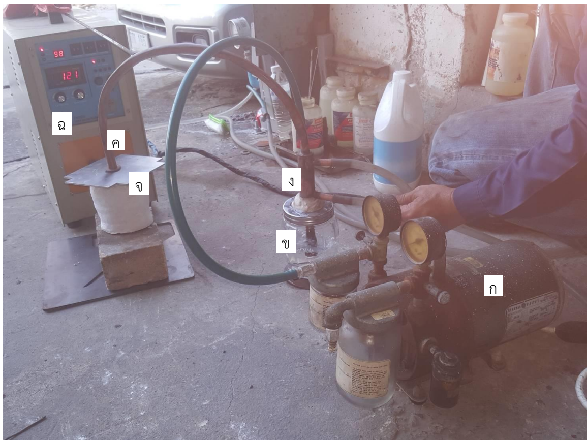
รูปที่ 3.27 แสดงการจัดเตรียมอุปกรณ์ทดลองเผาฝุ่นเหล็กในระบบปิดที่จัดเก็บไอระเห็ด โดยการควบแน่นด้วยน้ำภายใต้แรงดูดสุญญากาศ ก) เครื่องดูดอากาศ ข) ขวดเก็บไอระเห็ดสังกะสี ค) ท่อนำส่งไอระเห็ด ง) ส่วนลดอุณหภูมิไอระเห็ด จ) เบ้าเผาฝุ่นเหล็กที่ปิดกั้นอากาศให้ไหลเข้าได้ตามแรงดูดสุญญากาศ ฉ) เตาเหนี่ยวนำ
