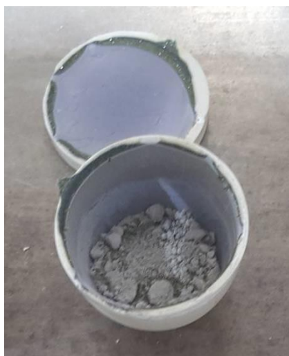
รูปที่ 4.29 แสดงโลหะสังกะสีที่เหลือยู่ปะปนกับสังกะสีออกไซด์ในเบ้า
