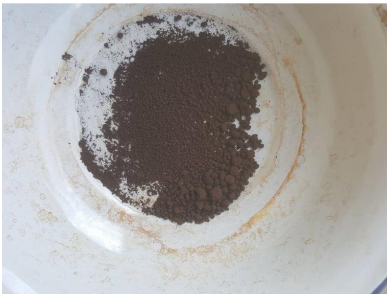
รูปที่ 4.5 แสดงการเกิดการหลอมตัวเกาะติดกัน (Sintering) ของฝุ่นเหล็กภายหลังการเผาที่ อุณหภูมิ 1,000 °C นาน 40 นาที
