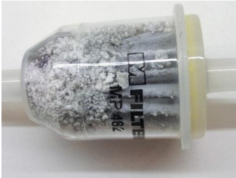
รูปที่ 2.27 แสดงสังกะสีออกไซด์ที่เก็บได้ด้วยแผ่นกรอง (Omran, Fabritius, Heikkinen, and Chen, 2017)
