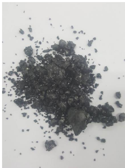
รูปที่ 2.37 แสดงตะกอนจากการถลุงฝุ่นเหล็กด้วยเตา Blast Furnace ของ บริษัท พี.เอส.พี.อุตสาหกรรมโลหกิจ จำกัด
