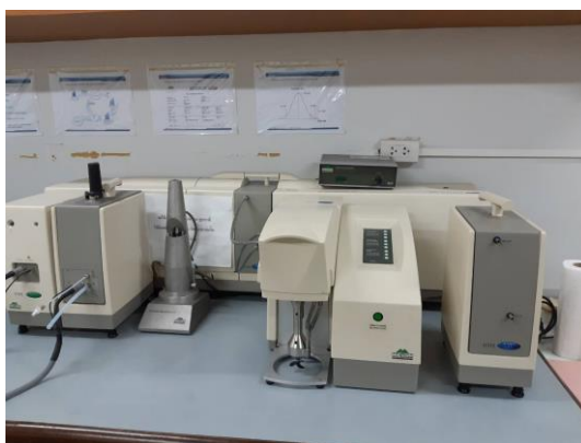
รูปที่ 3.21 แสดงเครื่องวัดการกระจายตัวของขนาดอนุภาคด้วยแสงเลเซอร์ (Laser Particle Size Distribution Analyzer) ยี่ห้อ Malvern รุ่น Mastersizer 2000
