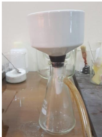
รูปที่ 3.25 แสดงอุปกรณ์สำหรับกรองที่ใช้ในการทำความสะอาดไอระเหยสังกะสีที่เก็บได้
