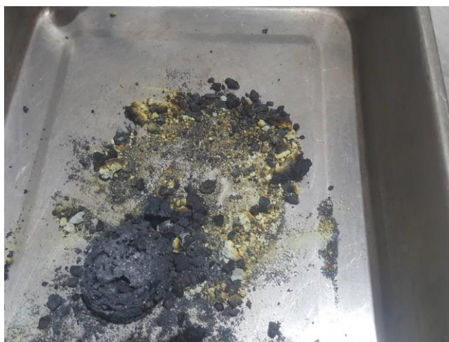
รูปที่ 4.13 แสดงลักษณะของตะกรันก้นเถ้าจากการทดลอง
