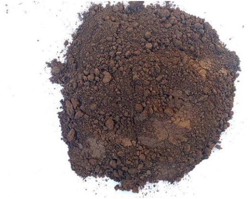
รูปที่ 2.35 แสดงลักษณะฝุ่นเหล็กก่อนเข้ากระบวนการเผาด้วยเตา Blast Furnace ของ บริษัท พี.เอส.พี.อุตสาหกรรมโลหกิจ จำกัด
