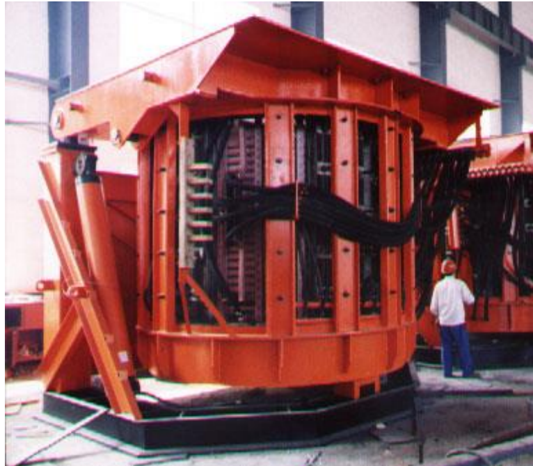
รูปที่ 3.31 เตาหลอมโลหะโดยการเหนี่ยวนำ (กรมพัฒนาพลังงานทดแทนและอนุรักษ์พลังงาน, 2552)
