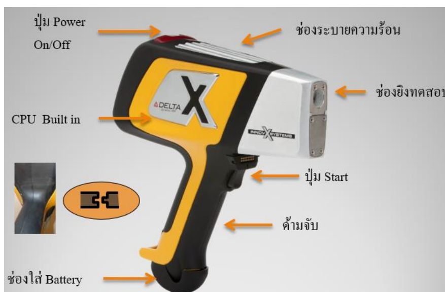
รูปที่ 3.39 ส่วนประกอบตัวเครื่อง XRF แบบพกพาของ OLYMPUS
