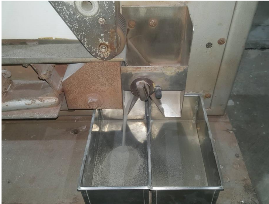
รูปที่ 4.8 แสดงการแยกแบริลเมไนด์จากหัวแหร่นักด้วยเครื่องแยกแรมแม่เหล็กไฟฟ้า (Induced Roll)
