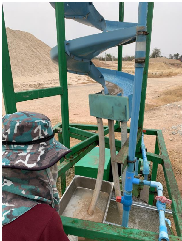
รูปที่ 4.7 แสดงวิธีการเก็บหัวแร่หนักเพื่อใช้เป็นแร่ป้อนในครั้งต่อไป
