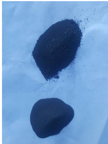
รูปที่ 4.22 เปรียบเทียบแร่โอลิเมนไนต์ (บน) หลังเผารีดักชัน (ล่าง) ก่อนเผารีดักชัน
