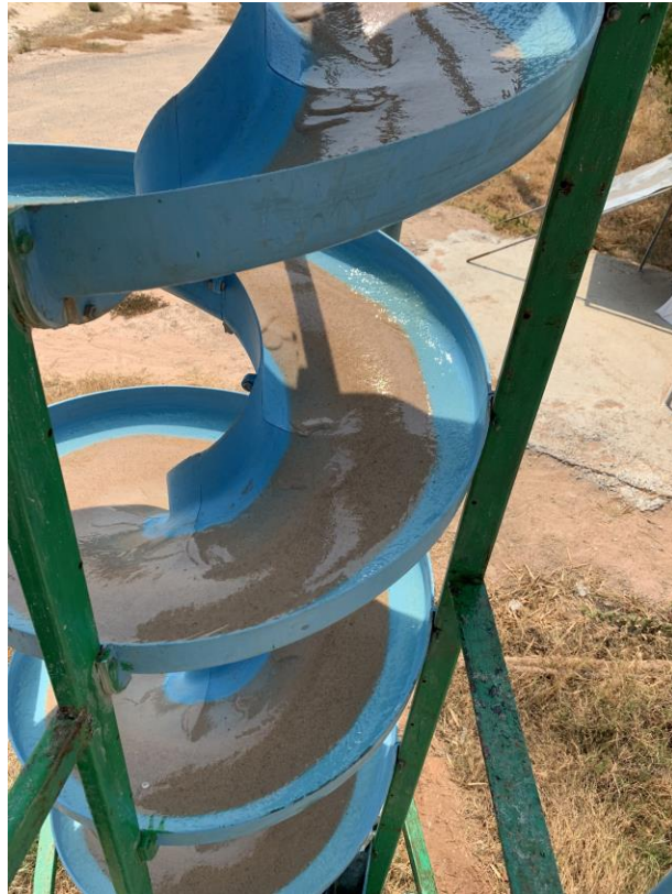
รูปที่ 4.6 แสดงลักษณะการกระจายตัวของแร่บนราง Reichert Spiral
