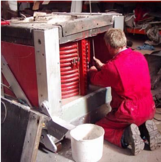
รูปที่ 3.34 ขดลวดเหนี่ยวนำของเตาหลอม (กรมพัฒนาพลังงานทดแทนและอนุรักษ์พลังงาน, 2552)
