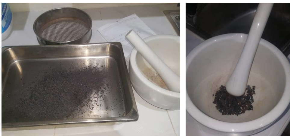
รูปที่ 4.31 การเก็บตัวอย่างอลิเมนไนต์หลังเผาออกซิเดชันที่อุณหภูมิ 1,150^\circ\text{C} นาน 60 นาที และรีดักชันที่อุณหภูมิ 1,360^\circ\text{C} นาน 30 นาที ก่อนทำการกวนพ่นอากาศ
