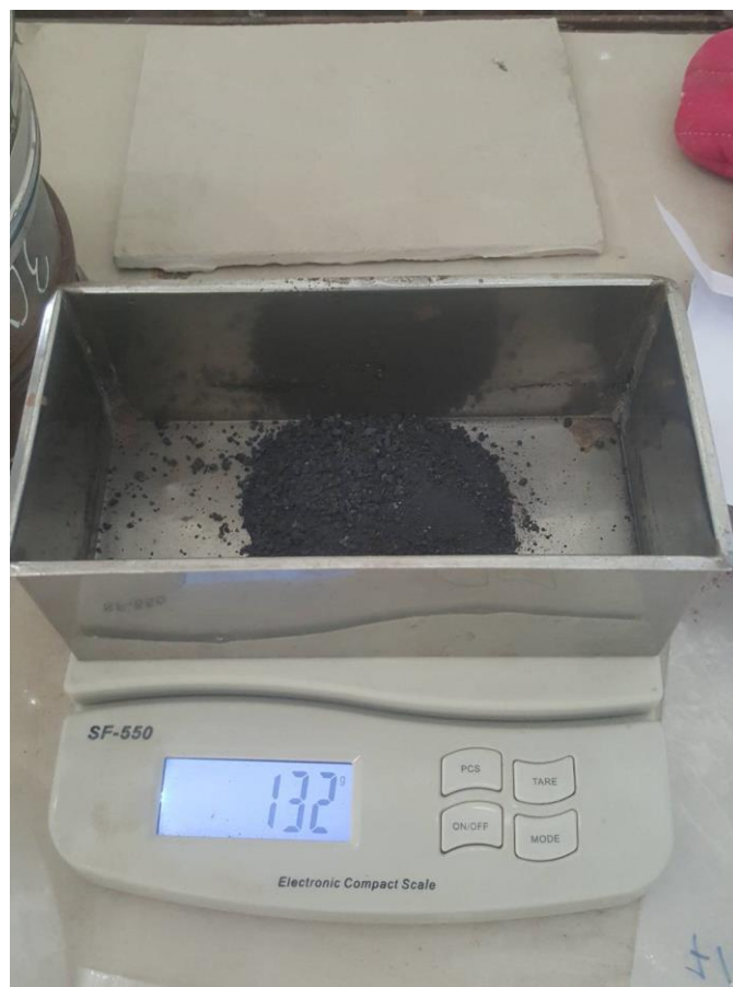
รูปที่ 4.21 แร่โอลิเมนไนต์หลังเผาไรต์กซ์ที่อุณหภูมิ 1,360 °C นาน 30 นาที
