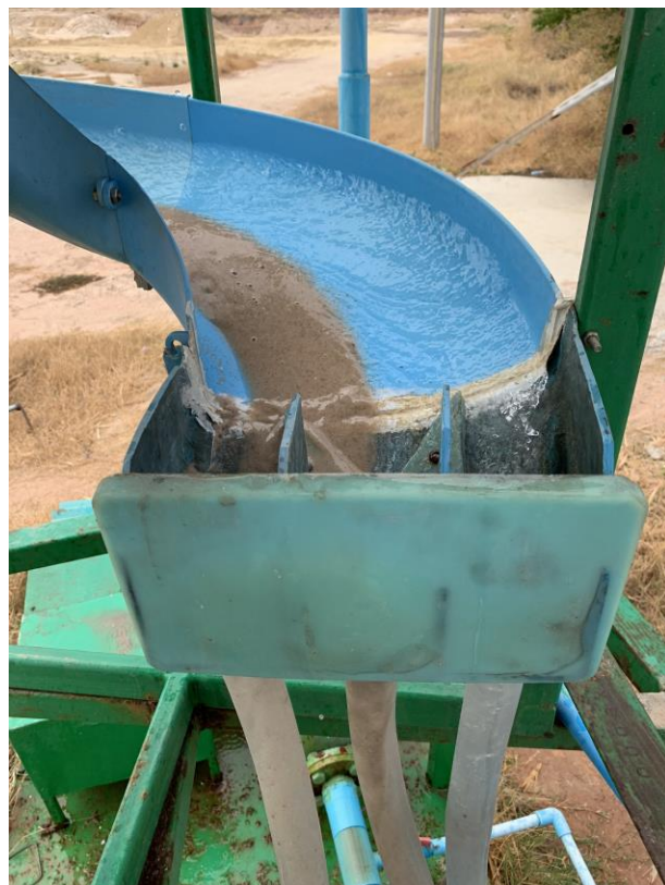
รูปที่ 4.5 แสดงลักษณะการปรับช่องแบ่งเก็บหัวแร้น้ำกับทรายในอัตราส่วน 30:70
