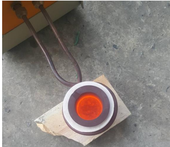
รูปที่ 4.13 แร่โอลิเมนไนต์ขณะเร่งอุณหภูมิเผาออกซิเดชันประมาณ 800 °C
