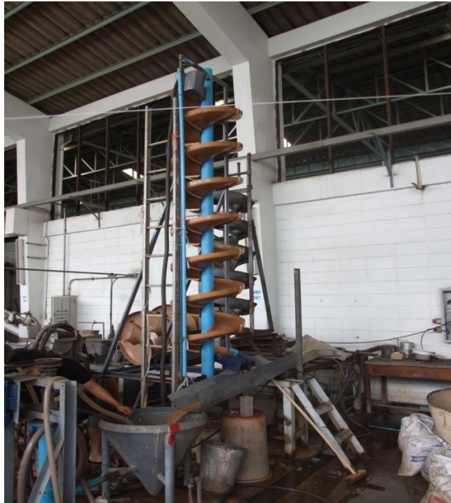
รูปที่ 3.4 เครื่องสไปรอล ที่กลุ่มแต่งแร่และใช้ประโยชน์แร่ กรมอุตสาหกรรมพื้นฐานและการเหมืองแร่ (กรมอุตสาหกรรมพื้นฐานและการเหมืองแร่, 2554)
