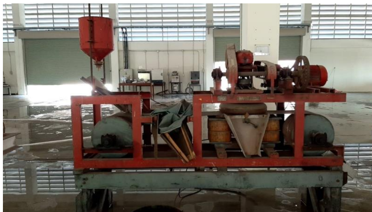
รูปที่ 3.12 แสดงเครื่องแยกแร่ด้วยแม่เหล็กแบบจาน (Rapid Magnetic Separator)
