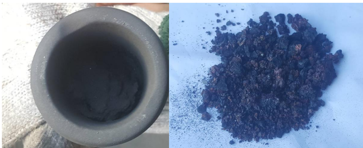
รูปที่ 4.23 ก) ลักษณะของโอลิเมนไนต์หลังเผารีดักชันภายในเบ้า ข) แร่โอลิเมนไนต์หลังเผารีดักชันเมื่อเทออกจากเบ้า
