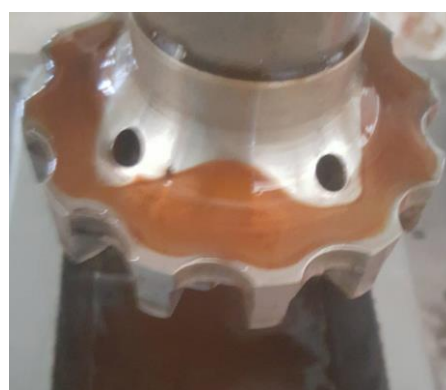
จ) หลังกวนพ่นอากาศ 180 นาที คราบสนิมเหล็กเกาะติดใบพัด
