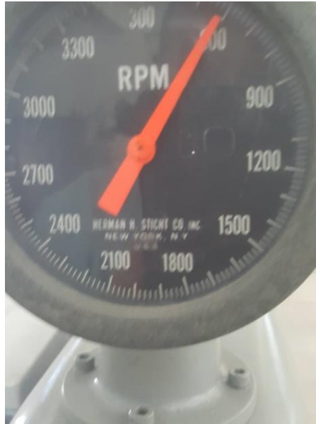
รูปที่ 4.32 ความเร็วรอบของใบพัดที่ใช้ในการกวนพ่นอากาศ (Aeration) ด้วยเครื่อง Flotation Sub-A
