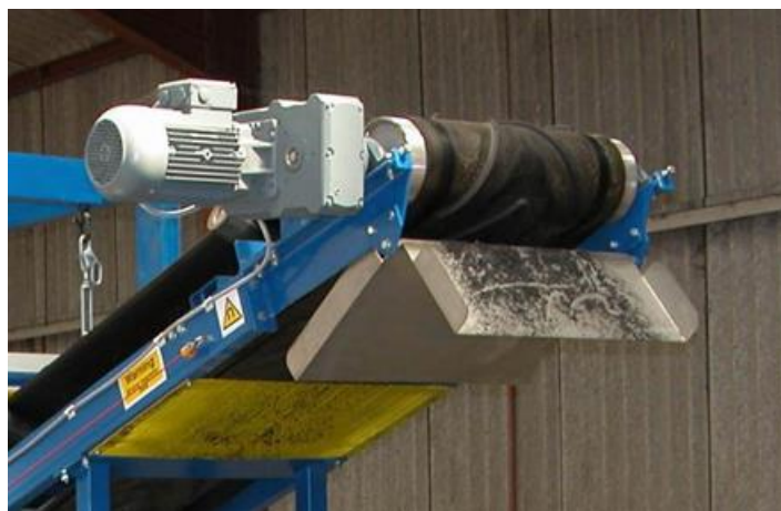
รูปที่ 5.2 แสดงสายพานแยกแร่ผ่านลูกกลิ้งแม่เหล็กกำลังสูง (Permanent Magnetic Separator)
