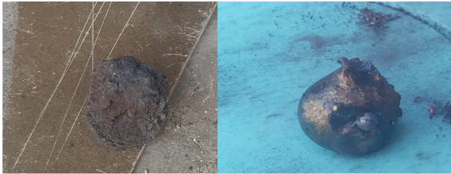
รูปที่ 4.24 (ซ้าย) แร่โอลิเมนไนต์หลังเผาที่อุณหภูมิ 1,360 °C นาน 10 นาที (ขวา) สะเก็ดโลหะที่ได้จากการเผารีดักชันขยาย 10 เท่า
