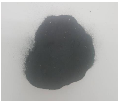
รูปที่ 4.15 แสดงตัวอย่างหัวแร่โอลิเมนไนด์หลังเผา (ออกซิเดชัน) ที่อุณหภูมิ 1,150 °C ที่เวลา 30 นาที
