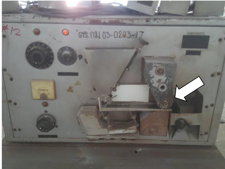
รูปที่ 3.10 แสดงเครื่องแยกแร่ด้วยแม่เหล็กแบบลูกกลิ้ง (Drum Magnetic Separator) ลูกศรแสดงตำแหน่งลูกกลิ้ง
