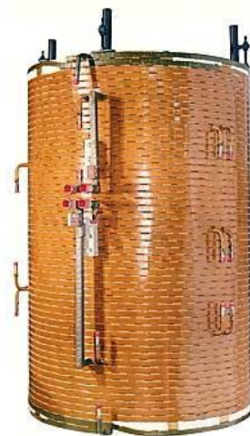
รูปที่ 3.34 ขดลวดเหนี่ยวนำของเตาหลอม (กรมพัฒนาพลังงานทดแทนและอนุรักษ์พลังงาน, 2552)
