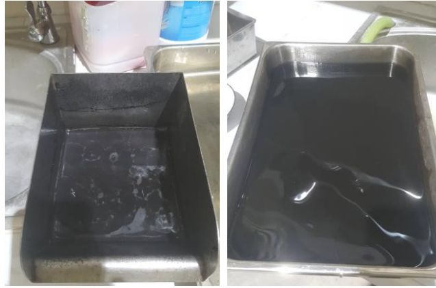
รูปที่ 4.36 ตัวอย่างส่วนผสมแร่และสารละลายกรดซัลฟูริก 0.5 โมลาร์ ภายหลังกักตุนนาน 30 นาที (ซ้าย) ในเครื่องกวนพ่นอากาศ (ขวา) ส่วนผสมที่ผ่านกระบวนการแล้วก่อนเทสารละลายและสารแขวนลอยทิ้ง
