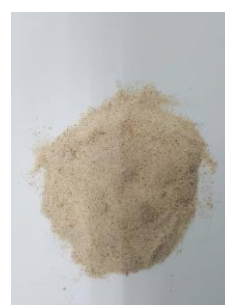
ซ) แร่ทิ้งจาก Reichert Spiral ของ บริษัท ผลิตภัณฑ์และวัตถุก่อสร้าง จำกัด
