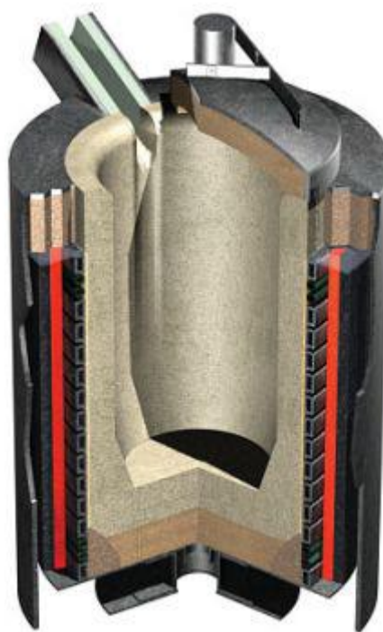
รูปที่ 3.32 เป้าหลอมโลหะโดยการเหนี่ยวนำ (กรมพัฒนาพลังงานทดแทนและอนุรักษ์พลังงาน, 2552)
