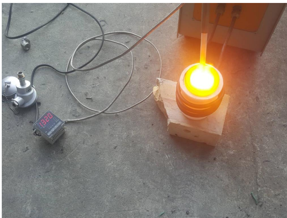
รูปที่ 4.19 แสดงการเผารีดักชันโดยไม่ปิดฝาเบ้าหลอม
