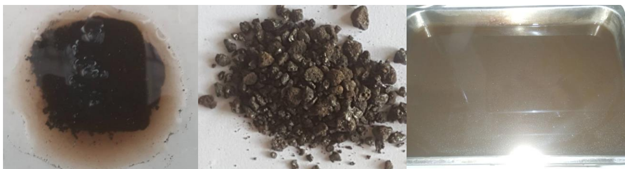
ค) สนิมเหล็กที่แขวนลอย ที่รินทิ้งหลังกวนพ่นอากาศ 180 นาที
