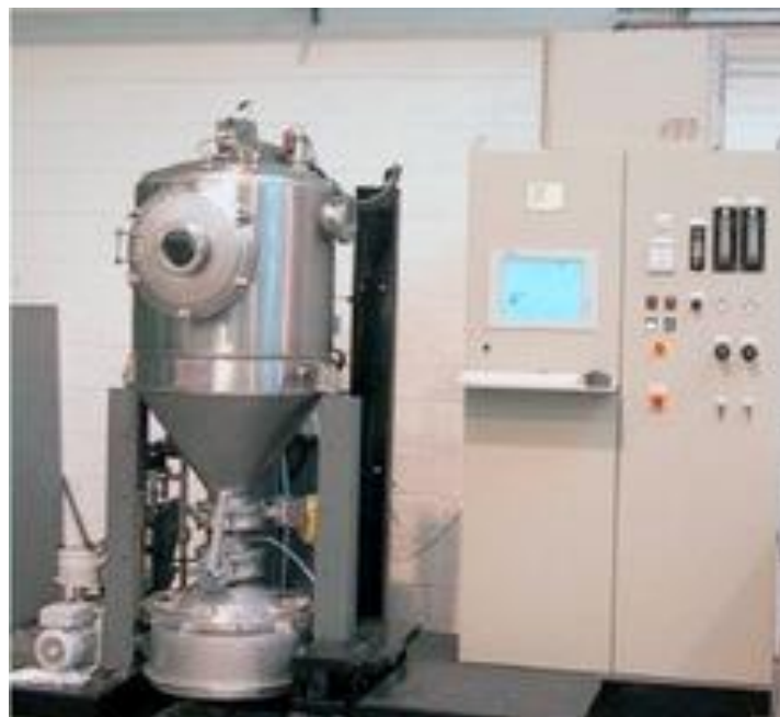
รูปที่ 4.12 เครื่องผลิตผงโลหะด้วยคลื่นความถี่สูง (Ultrasonic Atomizer) (ที่มา : https://dgvictory.en.alibaba.com )
