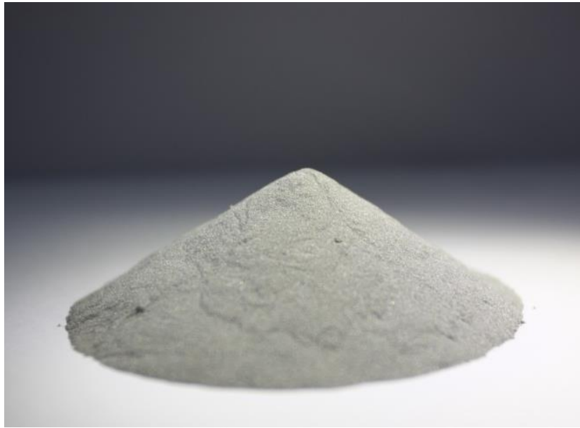
รูปที่ 4.14 ผงดิบที่ได้จากวิธีการพ่นลมด้วยแรงดันสูง (Air Atomization) (ที่มา : https://www.thaisarco.com )
