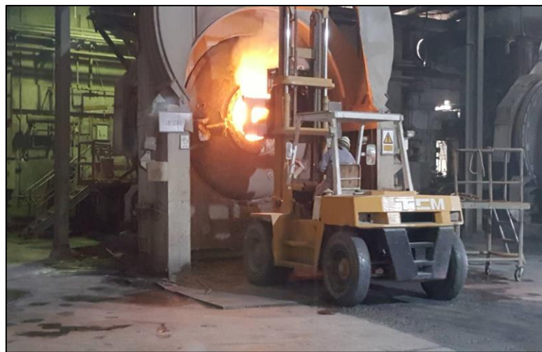
รูปที่ 4.12 การนำวัตถุดิบทั้งหมดใส่ลงไปในเตาหลอม
