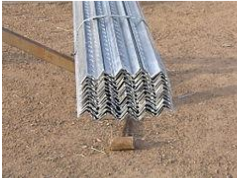
รูปที่ 2.3 การชุบเคลือบผิวเหล็กด้วยสังกะสี
