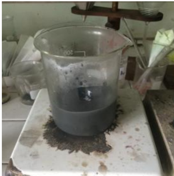
รูปที่ 5.10 การชะละลายฝอยเหล็กออกจากทอง
