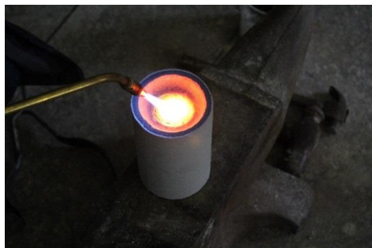
รูปที่ 5.12 การเพิ่มความบริสุทธิ์ของทองคำด้วยกระบวนการโลหวิทยาความร้อน
