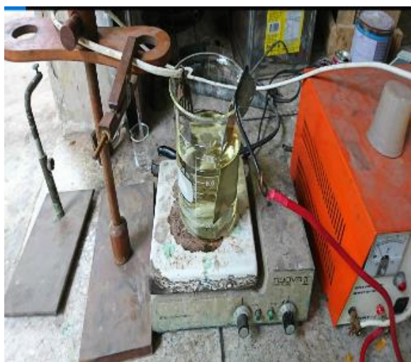
รูปที่ 5.9 การแยกทองออกจากสารละลายด้วยไฟฟ้าเคมี
