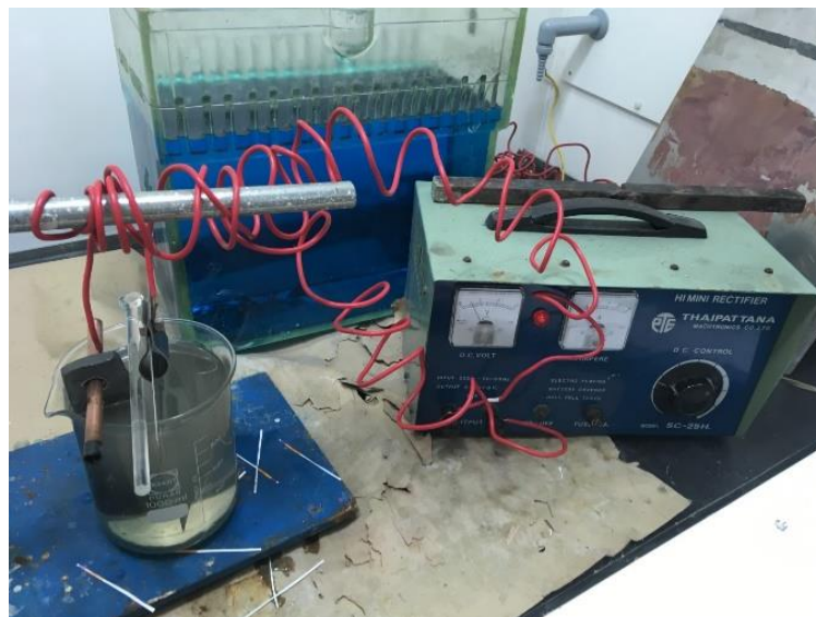
รูปที่ 5.20 การแยกสังกะสีออกจากสารละลายด้วยไฟฟ้าเคมี
