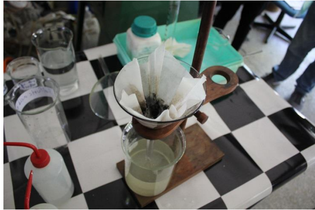
รูปที่ 5.13 การเพิ่มความบริสุทธิ์ของทองคำด้วยกระบวนการโลหวิทยาสารละลาย
