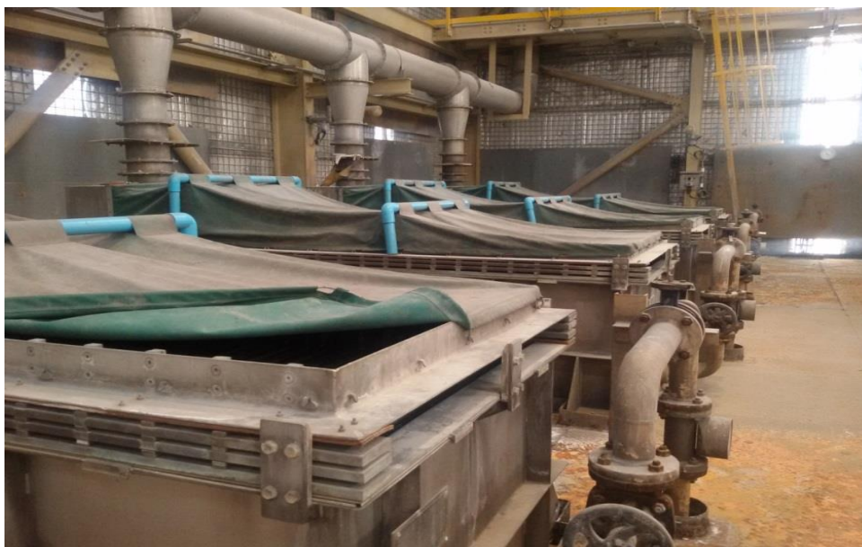
รูปที่ 4.6 การแยกโลหะทองคำออกจากสารละลายโดยใช้กรรมวิธีทางไฟฟ้าเคมี (ที่มา : บริษัท อัครา รีซอร์สเซส จำกัด (มหาชน))
