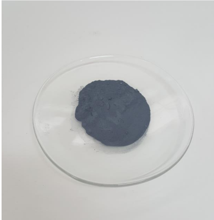
รูปที่ 5.15 ผุ่นสังกะสีที่ได้จากกระบวนการชุบร้อน
