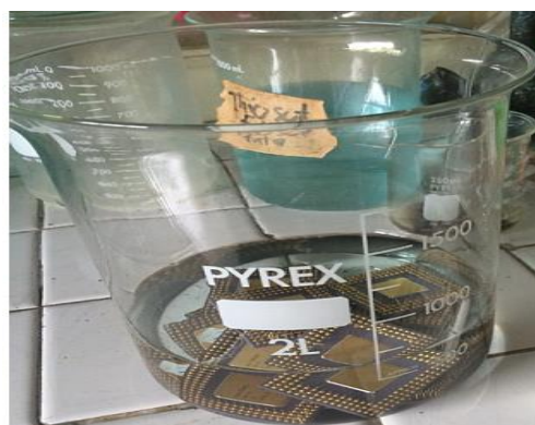
รูปที่ 5.6 กระบวนการชะละลายทองคำจากเศษซากซีพียู
