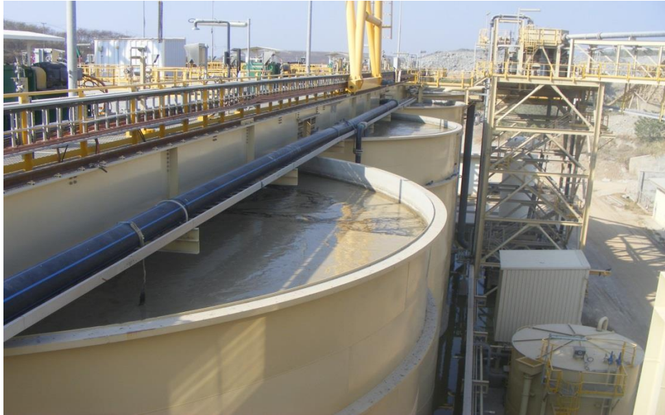
รูปที่ 4.5 ถังแช่สินแร่ในสารละลายไซยาไนด์ (ที่มา : บริษัท อัครา รีซอร์สเซส จำกัด (มหาชน))
