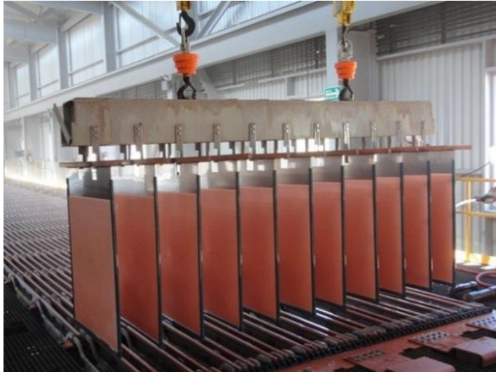
รูปที่ 3.4 กระบวนการ Electro-refining ของโลหะทองแดง (ที่มา : http://www.copperalliance.org.uk )
