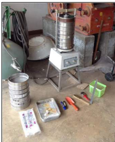
รูปที่ ๕ แสดงเครื่องสั่นตะแกรงและชั้นตะแกรง และชุดตะแกรงขนาดต่าง ๆ
