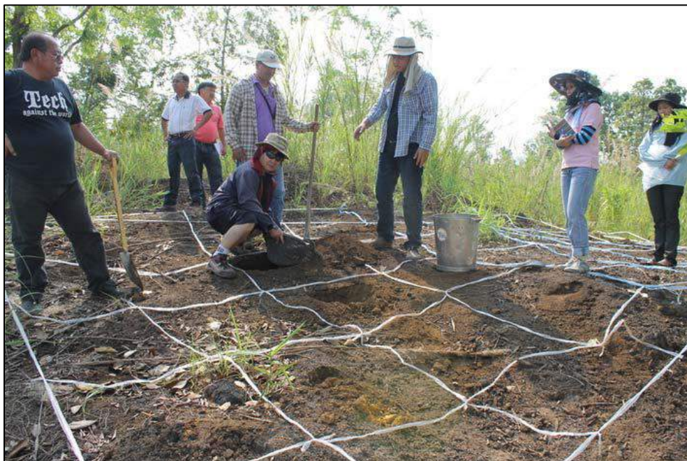
รูปที่ ๒ แสดงการวางแนวกริด (grid) เพื่อชักตัวอย่างแร่
