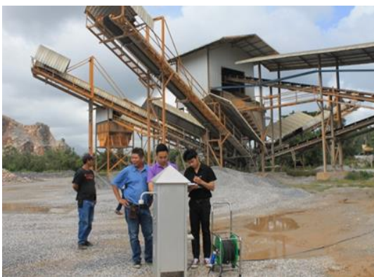
รูปที่ ๖.๔ การติดตามตรวจสอบและเฝ้าระวังคุณภาพสิ่งแวดล้อม บริเวณพื้นที่ประกอบการเหมืองแร่ในเขตพื้นที่ ๘ จังหวัด การตรวจติดตามพื้นที่สถานประกอบการ เพื่อวัดปริมาณฝุ่นละอองและเก็บตัวอย่างน้ำรอบสถานประกอบการ จำนวน ๒๕ เหมือง/ปีงบประมาณ
