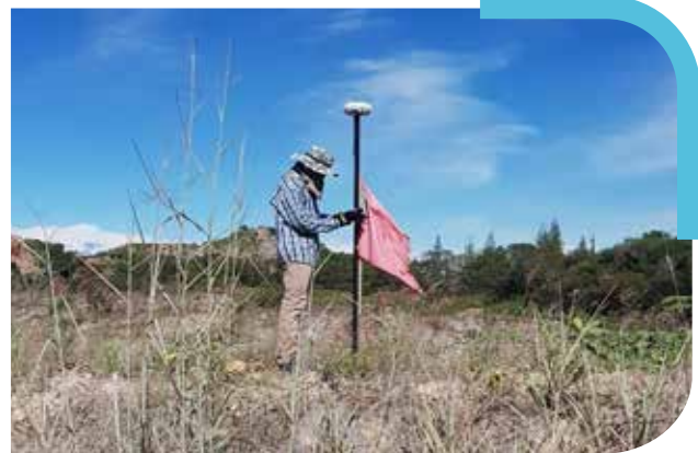
การรังวัดหลักหมายเขตประทานบัตรด้วยเครื่องรับสัญญาณดาวเทียม
