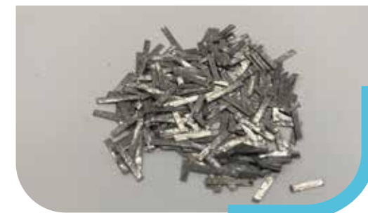
เทคโนโลยีรีไซเคิล Bus Bar หรือ PV Ribbon ในซากแผงเซลล์แสงอาทิตย์
