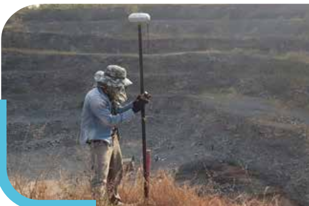
การรังวัดหลักหมายเขตประทานบัตรด้วยเครื่องรับสัญญาณดาวเทียม
