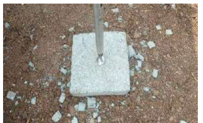
รูปที่ 3.6.1-3 แสดงการตรวจวัดค่าพิกัดและระดับหมุดหลักฐานตรวจสอบ (ต่อ)
