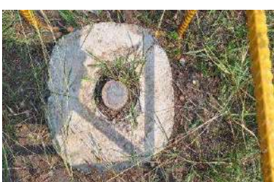
รูปที่ 3.6.1-3 แสดงการตรวจวัดค่าพิกัดและระดับหมุดหลักฐานตรวจสอบ
