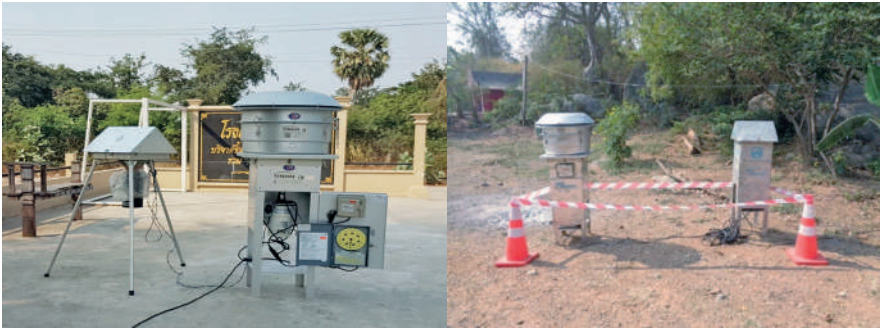
การตรวจวัดฝุ่นตามกำหนดในมาตรการป้องกันและแก้ไขผลกระทบสิ่งแวดล้อม
