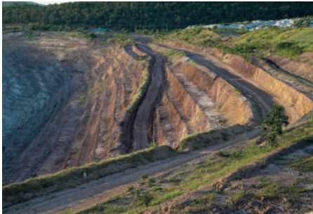
การทำเหมืองแบบขั้นบันไดและพื้นที่ฟูบริเวณที่ไม่ได้มีการทำเหมือง
