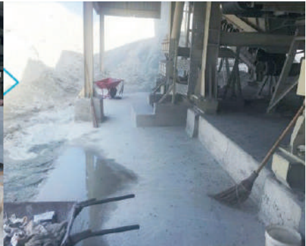
นำสายพานเก่ามาใช้ปิดคลุมปากโมเพื่อป้องกันฝุ่น
