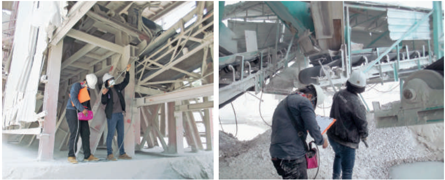
การตรวจวัดฝุ่นที่จุดกำเนิด (Opacity)
